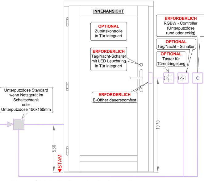
Leitung vom Schaltschrank zur Tür muss bauseits vorbereitet werden. Netzgerät für Hutschienemontage (3 Teilungsbreiten) im Lieferumfang enthalten Maße ca. B80 x H100 x T60 - Ca. 5m Kabel im Lieferumfang enthalten
