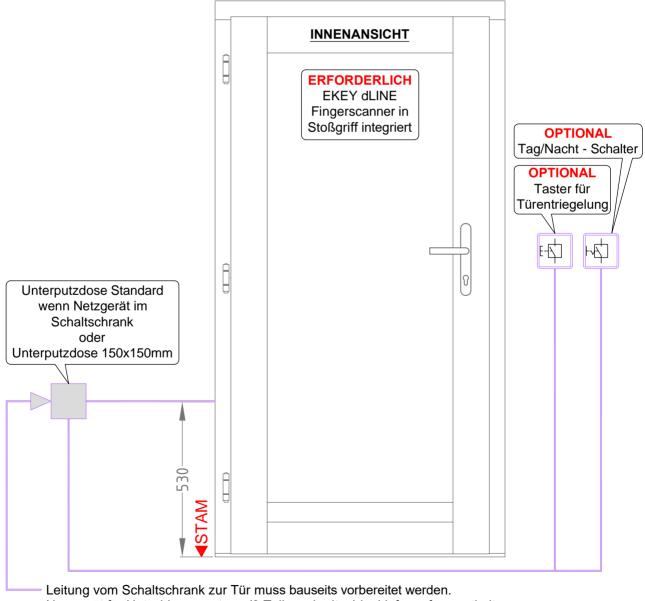
Netzgerät für Hutschienemontage (3 Teilungsbreiten) im Lieferumfang enthalten Maße ca. B80 x H100 x T60 - Ca. 5m Kabel im Lieferumfang enthalten
